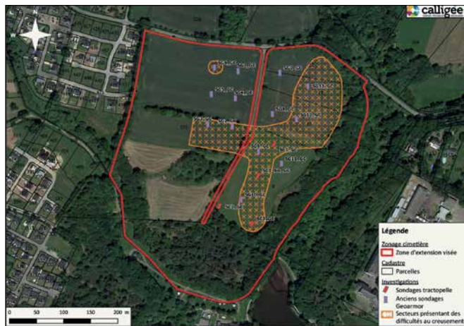
13 : Localisation des secteurs présentant des difficultés au creusement au droit du site du Grand-Cézac (sources : Geomarmor, 2008 et C
