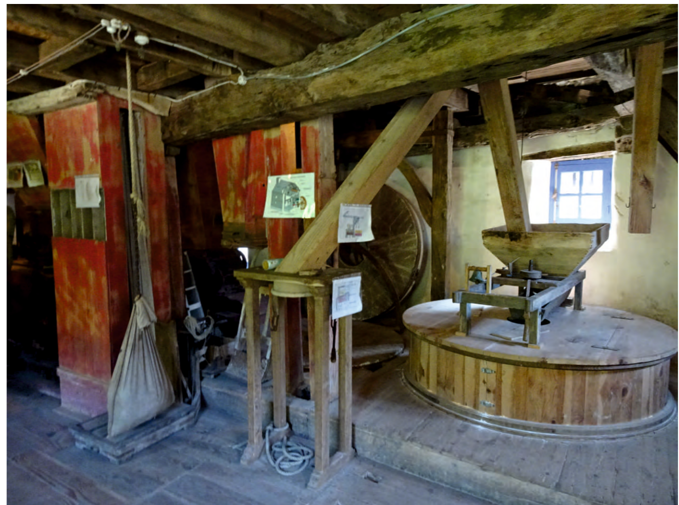
Ci-dessus : le moulin de Lancaï et sa grange (au 1er plan) dévolue à l'accueil du public ; ci-dessous : niveau de l'étage du moulin, la paire de meules dans son archure en bois et les élévateurs à godets
